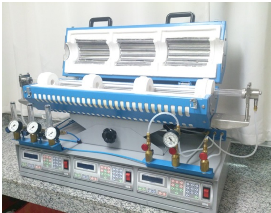
Figura 4.2 – Forno utilizado para a síntese de deposição química de fase vapor ( CVD ). Departamento de Física/UFLA.
