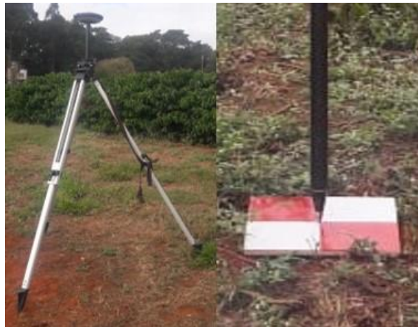
Fig. 6. Equipamentos utilizados do georreferenciamento dos pontos de controle.
