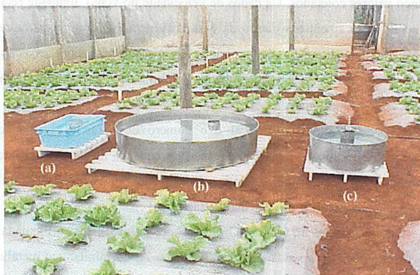
FIGURA 2 - Vista geral dos tanques evaporimétricos: minitanque de plástico (a), tanque Classe A (b) e minitanque metálico (c).
