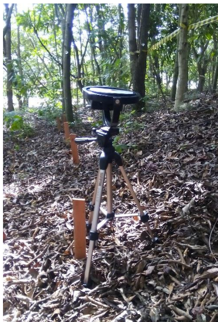
Figura 5 - Câmera fotográfica com lente olho de peixe acoplada ao autonivelador.
