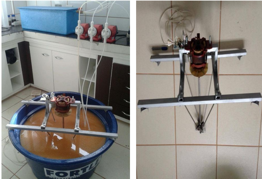
Figura 5 – Caixa de gordura sendo alimentada pelo reservatório de abastecimento por meio das bombas dosadoras. Em destaque o agitador utilizado para a homogeneização do efluente.
