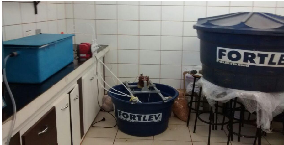
Figura 6 – Sistema de abastecimento da caixa de gordura montado para o terceiro teste.
