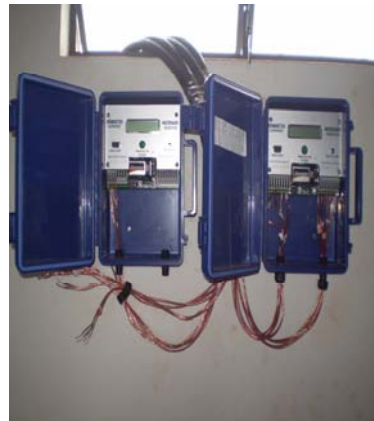
FIGURA 3F Estação de leitura do sensor matricial.
