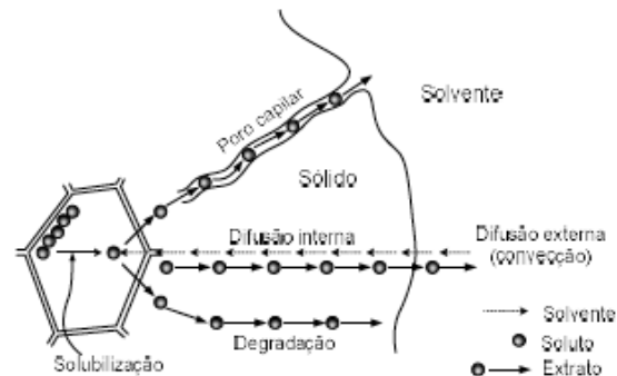
Figura 4 - Esquema dos processos envolvidos na extração sólido-líquido.
