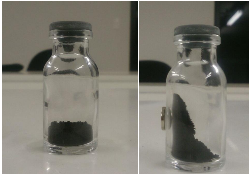
Figura 12: Ferrita de Cobalto obtida pelo método Pechini.
