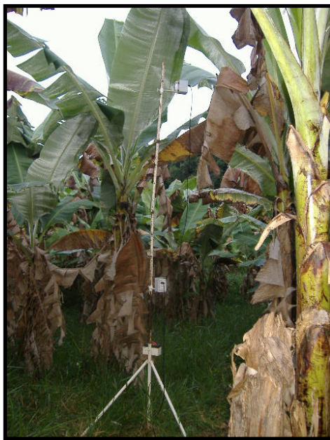
FIGURA 5: Torre montada, com coletores de esporos 'Rotorod Sampler' (R) instalada no centro do bananal. UFLA, Lavras, MG. 2008.
