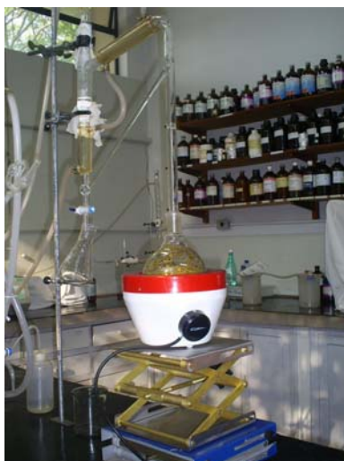
FIGURA 9 Aparelho de Clevenger modificado
