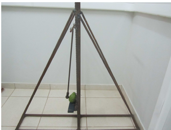
Figura 5 Pêndulo utilizado para produzir os impactos nas goiabas
