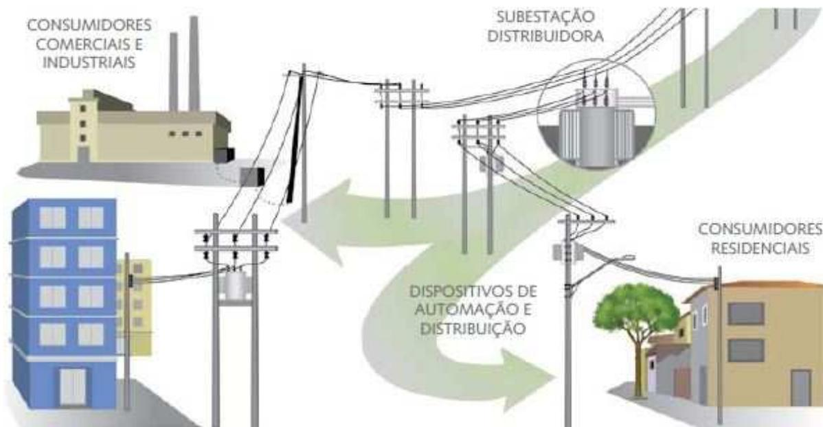
Figura 4 Circuitos elétricos de média tensão (cabos na horizontal), alimentando consumidores comerciais, consumidores industriais e dispositivos de automação e distribuição (chaves facas, chaves fusíveis, chaves repetidoras, transformadores, dentre outros); e circuitos de baixa tensão, que alimentam consumidores residenciais (cabos na vertical)
