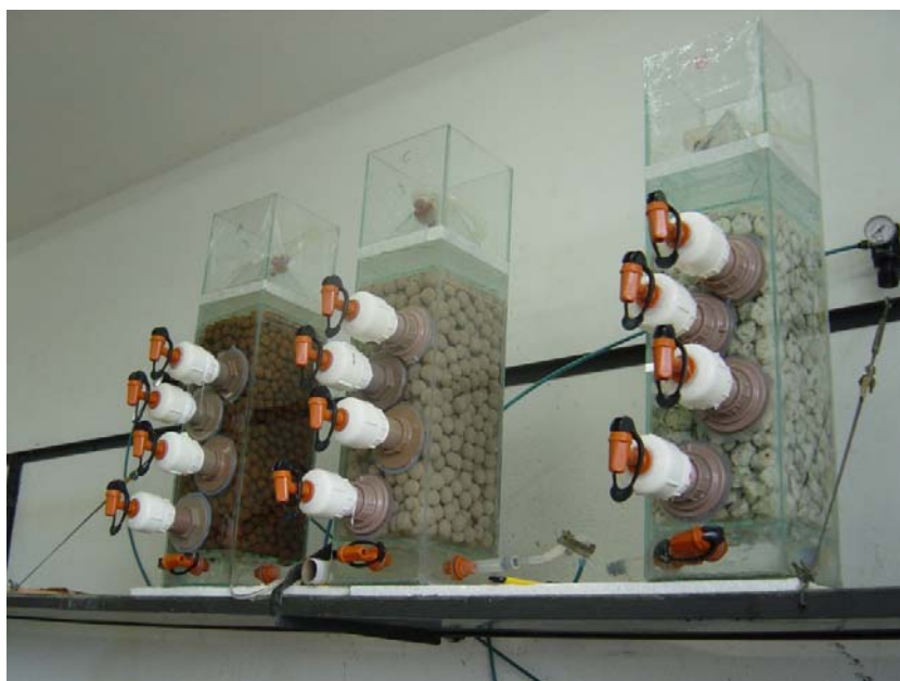
Figura 3 Biofiltros contendo os meios suportes argila expandida, pedra pomes e escória de alto forno sem inoculação
