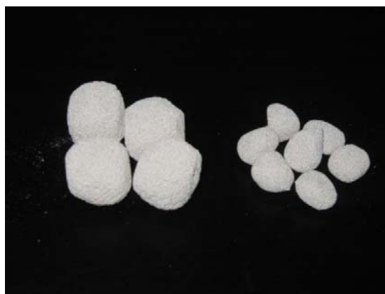
Figura 9 Meio suporte pedra pomes antes de ser colocada no biofiltro contendo a solução de \text{CuSO}_4 e após ser retirada da solução
