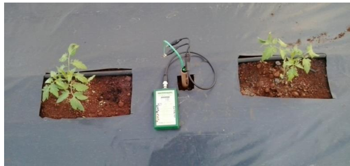
Figura 5 - Vista do medidor de potencial matricial do sensor watermark instalado na parcela experimental no interior da casa de vegetação. UFLA, Lavras, MG, 2015.
