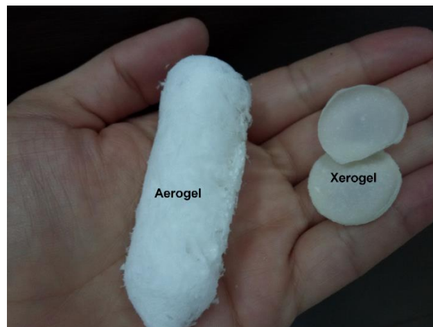
Figura 5 – Aerogel e xerogel produzidos com nanofibrilas de celulose.
