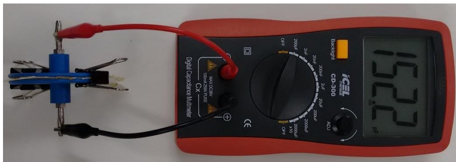
Figura 3: Medidas de capacitância pelo método de placas paralelas.
