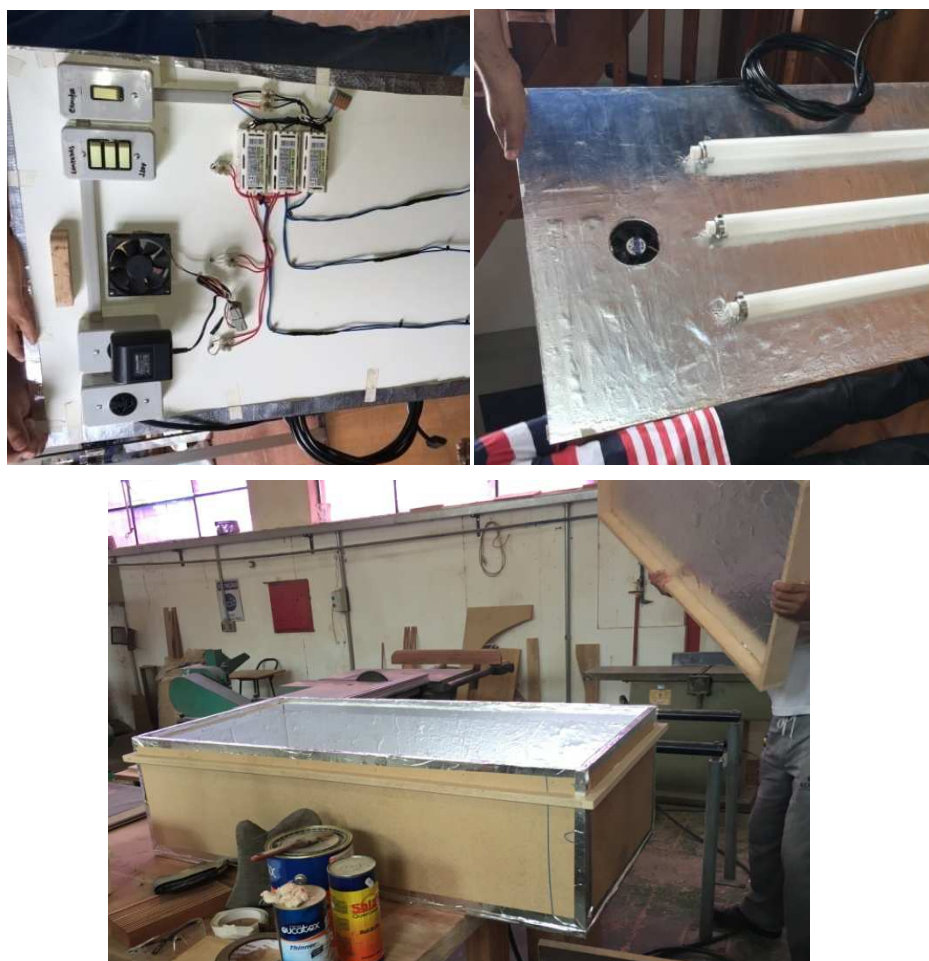
Figura 5 Montagem da câmara de fotodegradação e degradação por íons.
