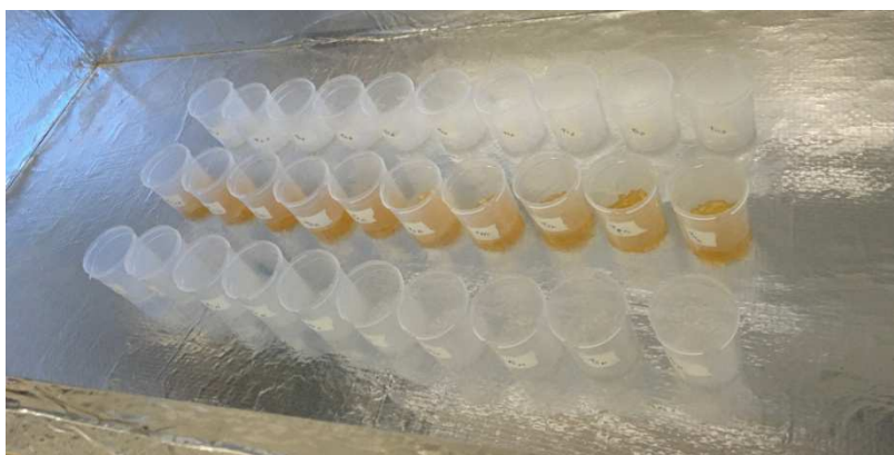
Figura 8 Cinética de degradação com amostras na câmara de fotodegradação e remoção a cada 3 horas num período de 48 horas.
