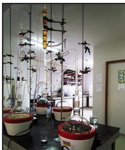
Figura 10 Processo de extração do óleo essencial (hidrodestilação)
