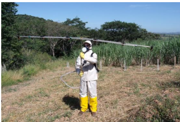
Figura 5 - Pulverizador costal de barra pressurizada com CO 2 munido de ponta modelo teejet-AIRX11002.
