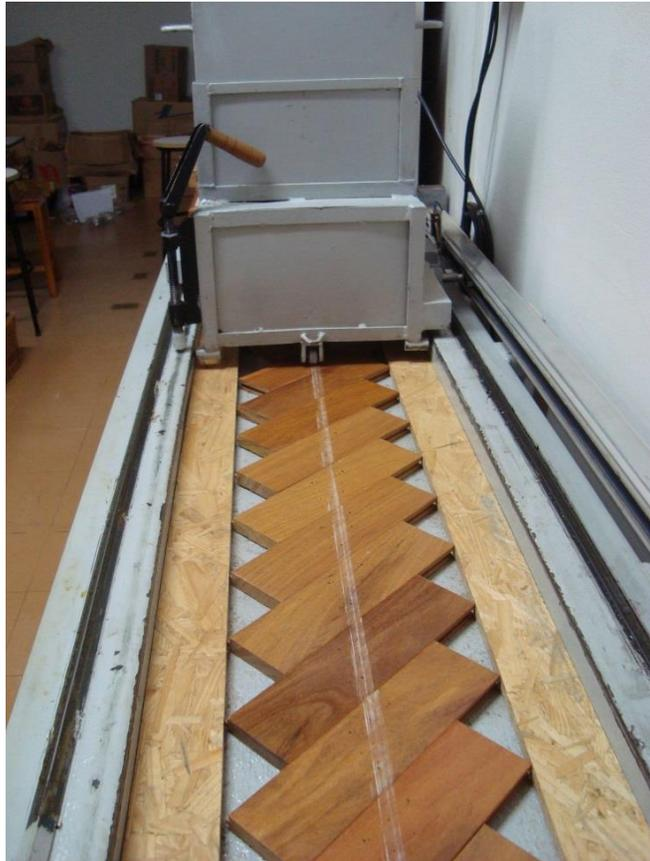
Figura 7 Setup do ensaio de carga rolante
