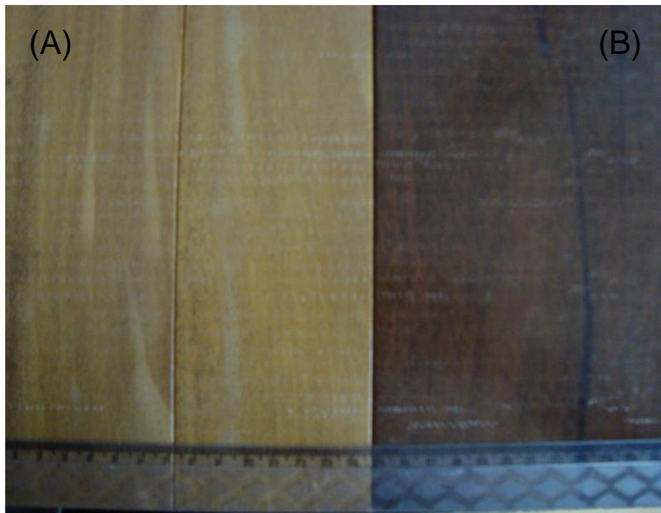
Figura 12 Ranhuras do ensaio de endentação causada por cargas aplicadas em pequenas áreas, após 100 viagens. Em que: A) madeira de cumaru e B) madeira de ipê
