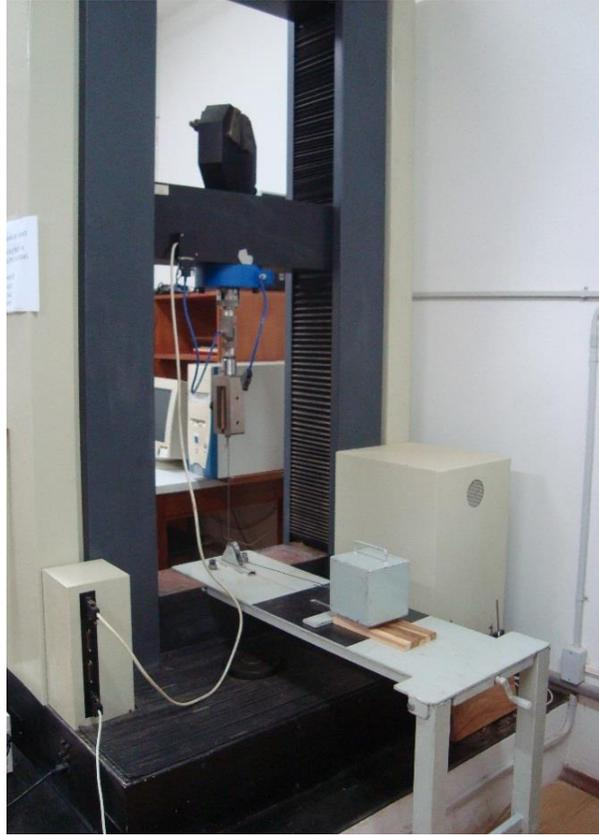
Figura 4 Setup do ensaio de atritos estático e dinâmico
